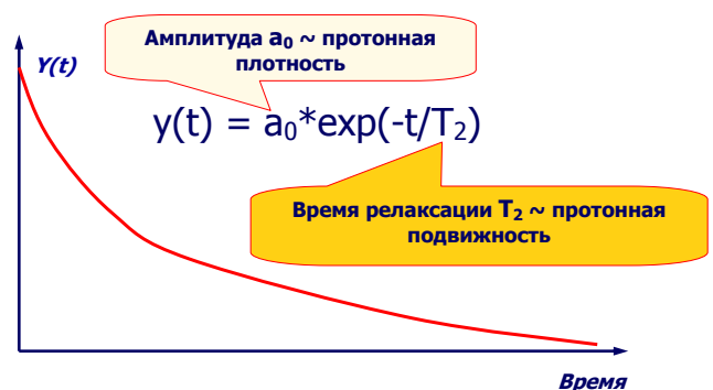
Рис. 3. Спад CPMG. T_2 характеризует протонную подвижность
