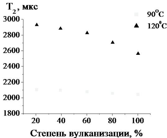
Рис. 4. Зависимость T_2 от степени вулканизации при разных температурах
